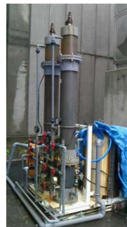
某金属鉱山(閉山)から、溶解性マンガン 2.7mg/L を含む廃水中の、Mn の除去生物ろ過実証実験をして欲しいとの依頼を受け、1 月 24 日から実証実験機を稼働させました。(写真一⑤) 3 月末まで実験をします。
