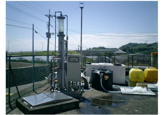
地下水中の硝酸イオンの生物脱窒実験（某市浄水場）
